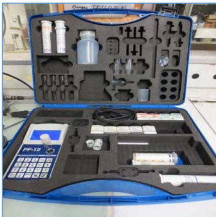
Analyse par photométrie de 5 paramètres physico-chimiques
